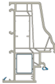
Blockblendrahmen hohe Bautiefe und beste Wärmedämmung
